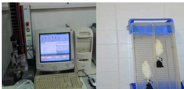
شکل ۲. (الف). دستگاه تست نیروی خمشی سه‌نقطه‌ای (ب). نردبان مخصوص تمرین قدرتی موش‌ها
