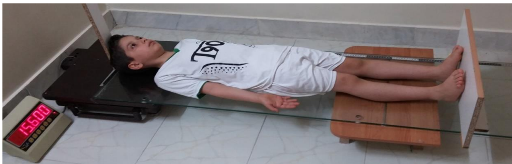
شکل ۱. نمونه‌ای از آزمودنی در وضعیت درازکش روی تخته توزین دستگاه اندازه‌گیری مرکز جرم
