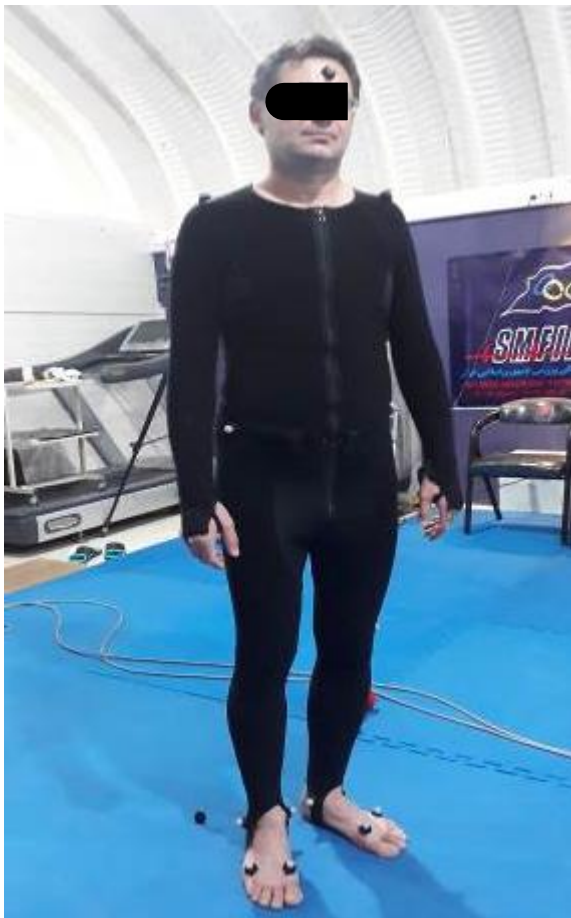
تصویر ۱. محل نصب مارکرها روی بدن آزمودنی‌ها
