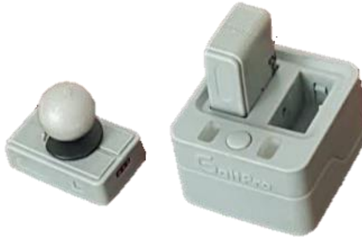
شکل ۱. حسگر اینرسی و مارکر بازتابی نصب شده روی آن برای بررسی همزمان سرعت با دو ابزار
