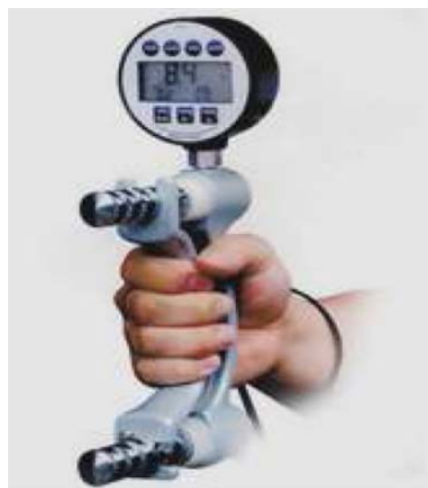
شکل ۱. نحوه اندازه‌گیری قدرت ایزومتریک عضلات دست با استفاده از داینامومتر دیجیتال
