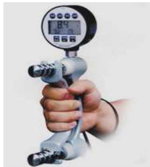
شکل ۱. نحوه اندازه‌گیری قدرت ایزومتریک عضلات دست با استفاده از داینامومتر دیجیتال
