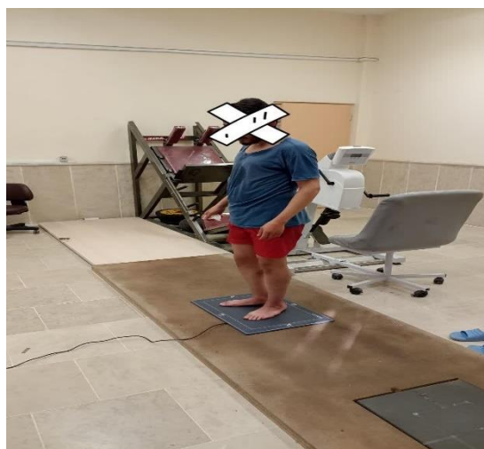
شکل ۲. ایستادن آزمودنی روی دستگاه فوت اسکن جهت اسکن پا
