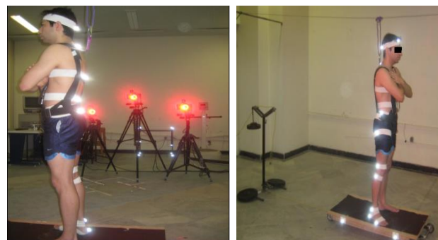
شکل ۱. نحوه قرارگیری مارکرها (الف، ب) و نحوه استقرار دوربین‌ها (ب)
