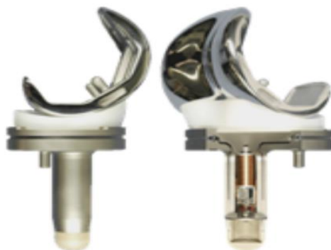
شکل ۱. ایمپلنت مجهز به حسگر
